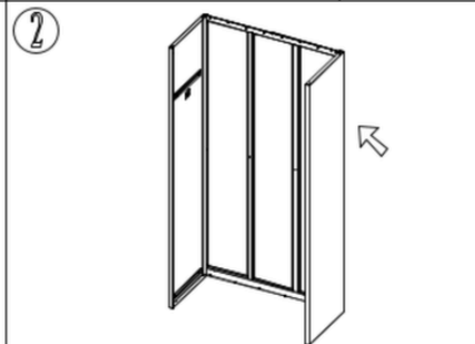
2 Befestigen Sie die rechte Seite auf die gleiche Weise an der Rückwand.
