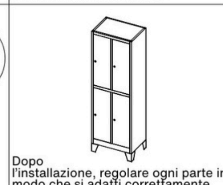
6 Installare il pannello superiore e quindi regolare i divisori superiore e inferiore finché non si adattano correttamente.
