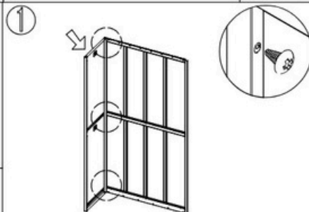
Priskrutkujte ľavú stranu a zadnú dosku samoreznými skrutkami (5x10)
