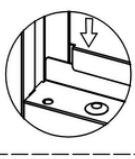
Встановіть нижню панель, потім закріпіть роздільну панель відповідно до позначок.
