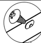
Прикріпіть ліву бокову панель до задньої панелі за допомогою самонарізних гвинтів (5x10).
