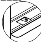
Monter toppladen, og fastgør den med skruerne (5x10).
