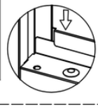
Monter bundpladen, og fastgør derefter skillepladen i henhold til markeringerne.
