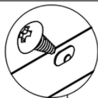
Fastgør venstre sidepanel til bagpanelet med de selvskærende skruer (5x10).
