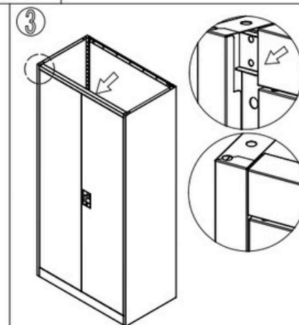
Zamocuj ramę drzwi do obu ścian bocznych.
