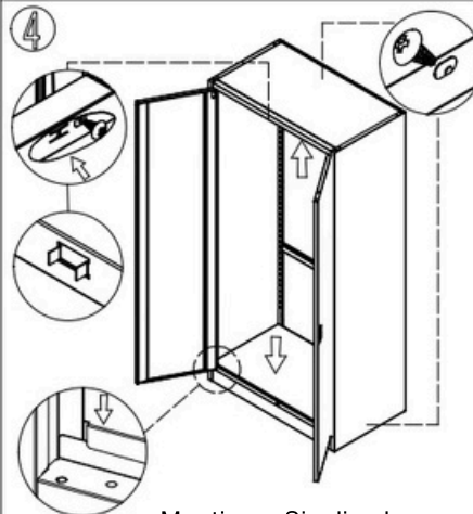
Montieren Sie die obere und die untere Abdeckung.
