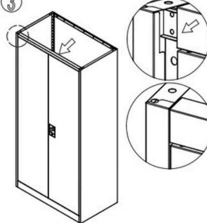
Befestigen Sie den Türrahmen an beiden Seitenwänden.
