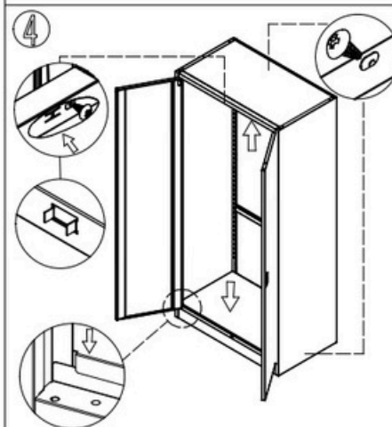
Fixe o lado esquerdo e o painel traseiro com parafusos autorroscantes (5x10).
