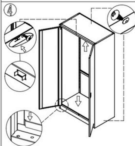
Bevestig de linkerzijde en het achterpaneel met zelftappende schroeven (5x10).
