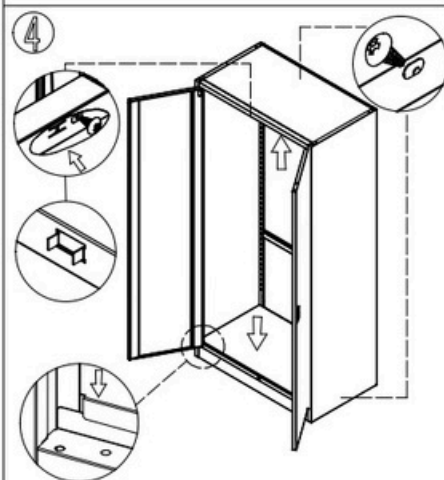
Installare il pannello superiore e quello inferiore.
