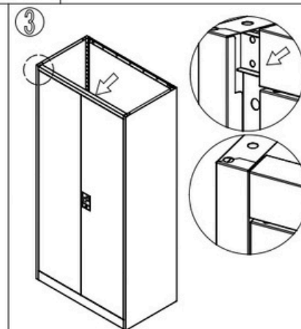
Fixe a estrutura da porta a ambos os lados.
