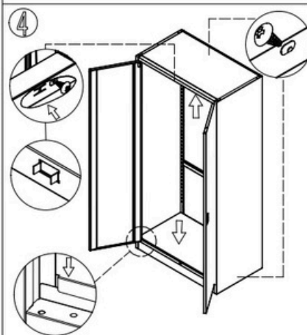
Fije el lado izquierdo y el panel trasero con tornillos autorroscantes (5x10).
