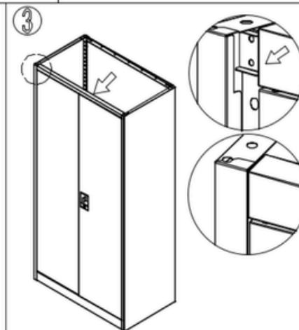
Pritrdite okvir vrat na obe stranski plošči
