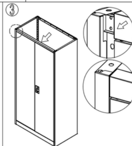
Fixează cadrul ușii de ambele panouri laterale
