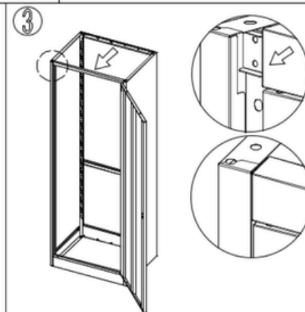
Kiinnitä ovenkarmi molempiin sivupaneeliin
