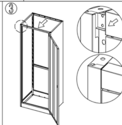
Bevestig het deurkozijn aan beide zijpanelen
