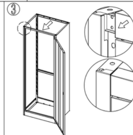
Kinnita ukseraam mõlema külgpaneeli külge
