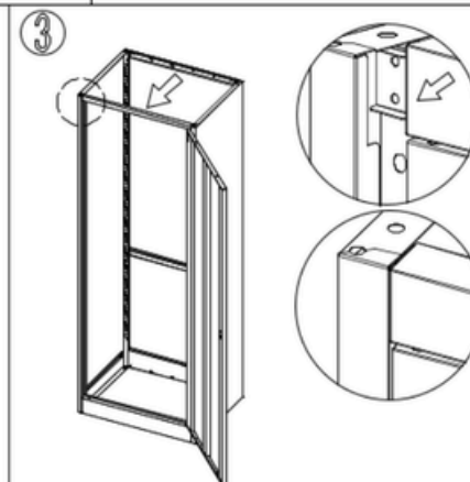
Befestigen Sie den Türrahmen an beiden Seitenteilen
