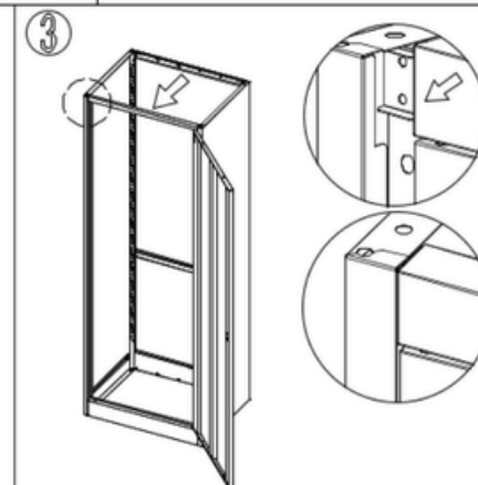
Fixez le cadre de la porte aux deux panneaux latéraux
